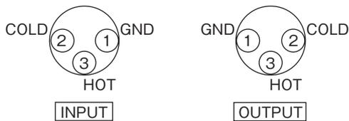
本機では、①のヨーロッパ方式を採用しています。XLRコネクタケーブルを使用する場合、USA方式を採用している機器に接続する場合、信号が逆位相になります。その場合は、片側のXLRコネクタの②ピンと③ピンをヨーロッパ方式となるようにつなぎ換えてください。
